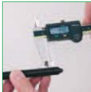
c Messen Sie die Länge über 3 Gewindegänge. Measure the length over three thread turns.
