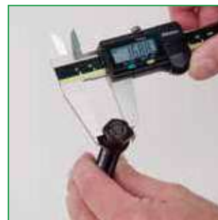
d Zmierz sześciokąt końcówki wrzeciona.
