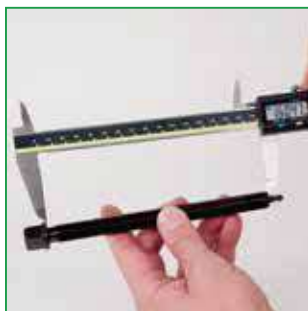
b Zmierz długość gwintu, aż do końcówki wrzeciona.
